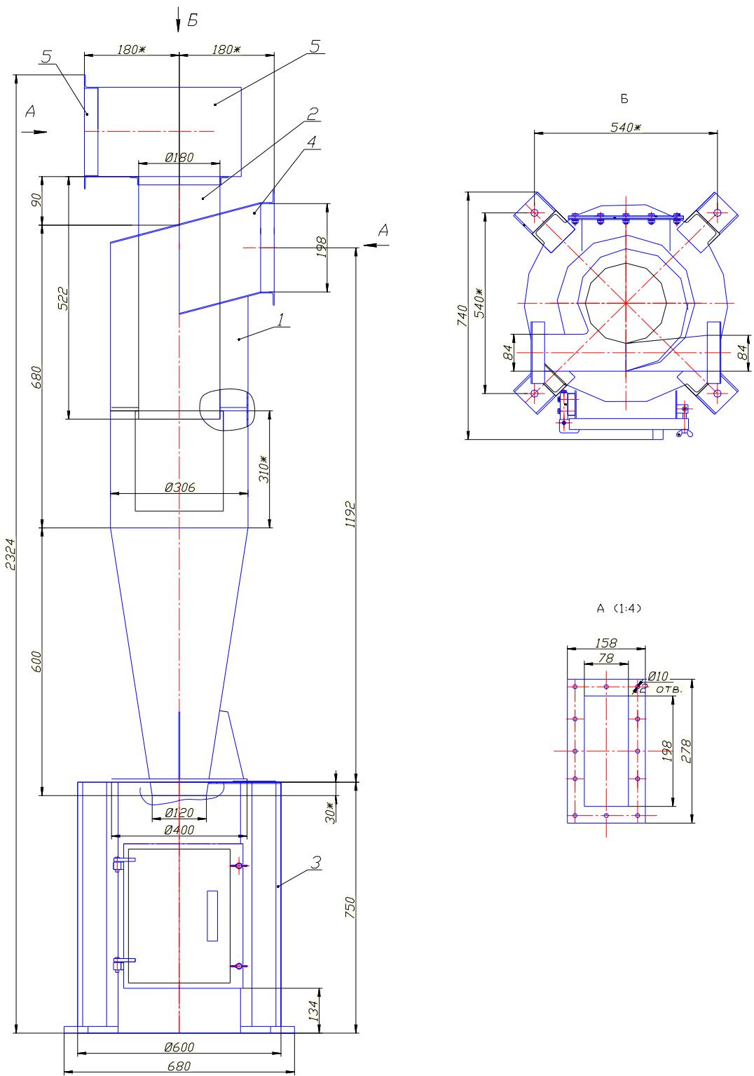
Рис.1 – Общий вид циклона ЦН 15-300 и его размеры
