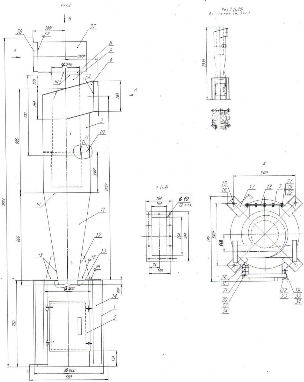
Рис.1 – Общий вид циклона ЦН 15-400 и его размеры.
